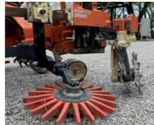
Alternative già presenti nei compresori viticoli: disco motrice, la lama ed il vomere tutti doppi e dotati di tastatori per il rientro automatico e ancora il Rollhacke e il Fingerhacke sempre per la lavorazione meccanica sottochioma.
